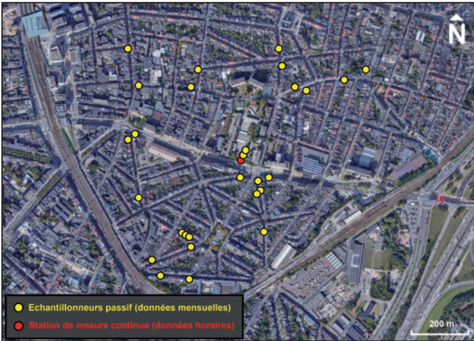
Figure 1. Photographie satellite de la zone d'étude (Géoportail) précisant la localisation des échantillonneurs passifs de NO 2 (ronds jaunes) ainsi que la station de mesure automatisée de qualité de l'air (rond rouge) de l'agence flamande pour l'environnement
